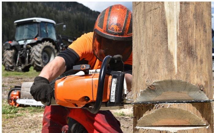
Kombinationsschnitt, Fallkerb- und Fällschnitte, Zielhacken und Kettenwechsel standen am Programm.
